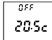
Betriebsmodus OFF Thermostat ausgeschaltet
